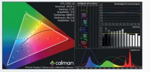
**Farbmessung HDTV Full-HD BT.709 8 Bit** Dreht man das Backlight auf, wird das Bild im Schnitt deutlich heller als in HDR und besitzt im Vergleich die mit Abstand größte Flächenstrahlung – bei sehr sauberen Farben.
