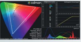
**Farbmessung Ultra-HD HDR BT.2100 12 Bit** Die höchste Leuchtkraft von 582 cd/m<sup>2</sup> wird nur im eiskalten Dynamikmodus erzielt. Grundsätzlich hellt der JXW das Bild etwas auf, um Details nahe des mauen Schwarz zu zeigen.
