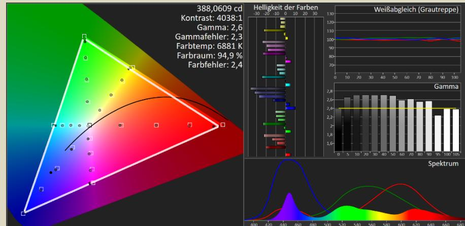
**Bildmessung HDTV:** Im Filmmakermodus mit voll aufgedrehtem Backlight gibt es saubere Farben bei guter Leuchtkraft.
